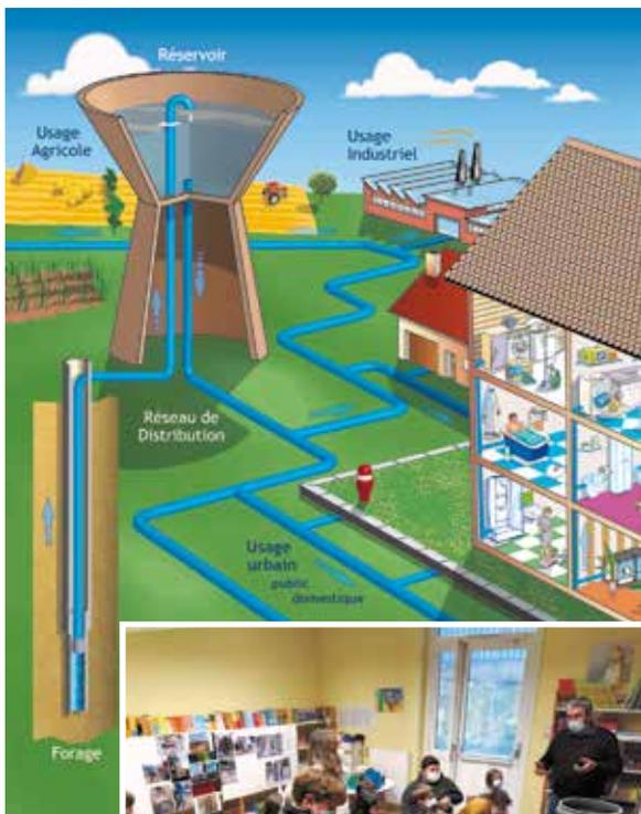
L'eau est pompée par deux pompes de 50m<sup>3</sup>/H qui fonctionnent alternativement. Elles sont placées à moins 55 mètres dans le forage.
