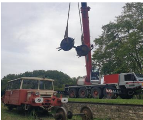
Grutage des essieux de la draisine pour révision à Brive.
